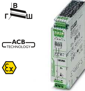
Активный модуль резервирования 24 В пост. тока, 2x 10 А, 1x 20 А
