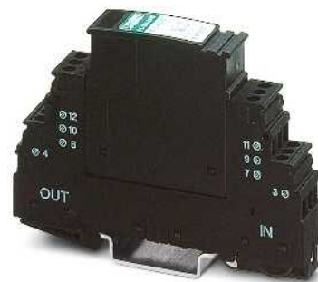
УЗИП штекерной конструкции с винтовыми зажимами, для пяти проводников, с общим опорным потенциалом
